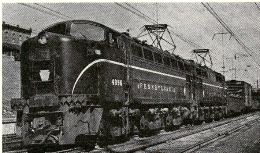
Pennsylvania Railroad's 341 t tunge dobbeltlokomotiv (seks 2-akslede bogier) for 25 p/s vekselstrøm. Det har ignitronensrettere og jævnstrømsbanemotorer. Det kan uden vanskelighed køre ved 60 p/s vekselstrøm.
